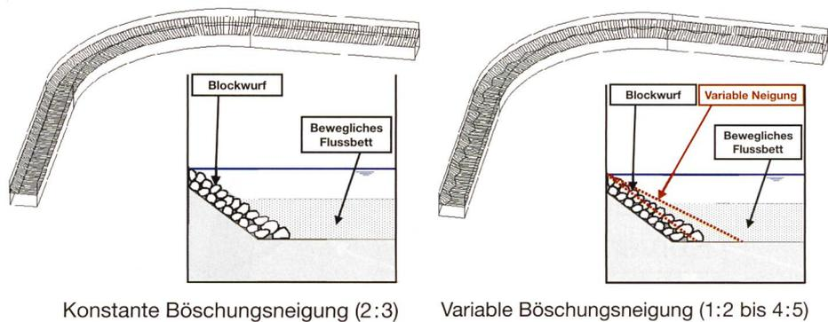
**Bild 1. Untersucher Blockwurf an der Kurvenaussen- (links) und variabler Neigung mit geschlängelter Fusslinie (rechts).**
