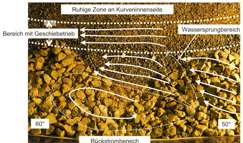
**Bild 6. Draufsicht auf Sohlenmorphologie in der Nähe der Kurvenaussenseite (stationärer Zustand nach  $Q = 100 \text{ l/s}$ , Lage zwischen  $50^\circ$  und  $60^\circ$  in Kurve).**
