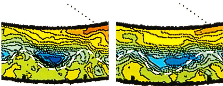
**Bild 10. Lokale Kolke in den Buchten für einen Blockwurf mit geschwängelter Fusslinie. Links: Ausbuchtungen mit konstanter Neigung. Rechts: Optimierte Ausbuchtung mit reduzierter Neigung (vgl. Bild 8). Die gestrichelte Linie markiert den Fuss des Blockwurfes.**
