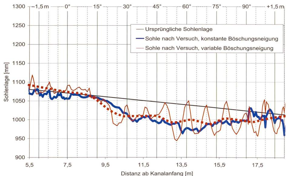
**Bild 7. Vergleich der Längenprofile der Sohlenlage für die beiden Blockwurfgeometrien ( $R = 6100 \text{ mm}$ ,  $Q = 100 \text{ l/s}$ ). Die rot gestrichelte Linie entspricht der mittleren Sohlenlage für den Blockwurf mit variabler Neigung.**
