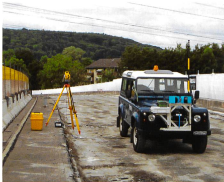
Bild 4. Landrover mit Laserscannern.
