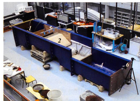
Figure 3. Banc d'essais large 1. Réserve d'eau amont 2. Siège du fusible 3. Dessableur 4. Bac de rétention 5. Sondes ultrasons 6. Caméra frontale
