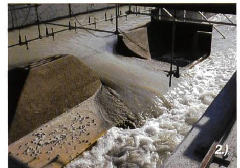
Figure 8. 1) Ouverture de la brèche 2) Allongement de l'ouverture.
