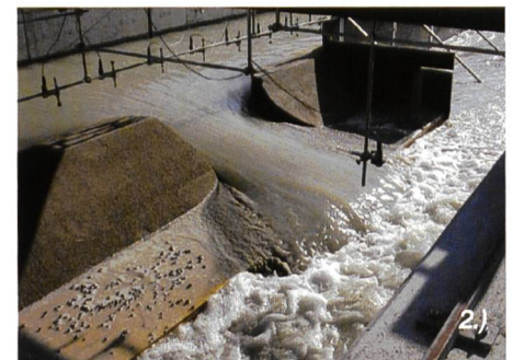
Figure 8. 1) Ouverture de la brèche 2) Allongement de l'ouverture.
