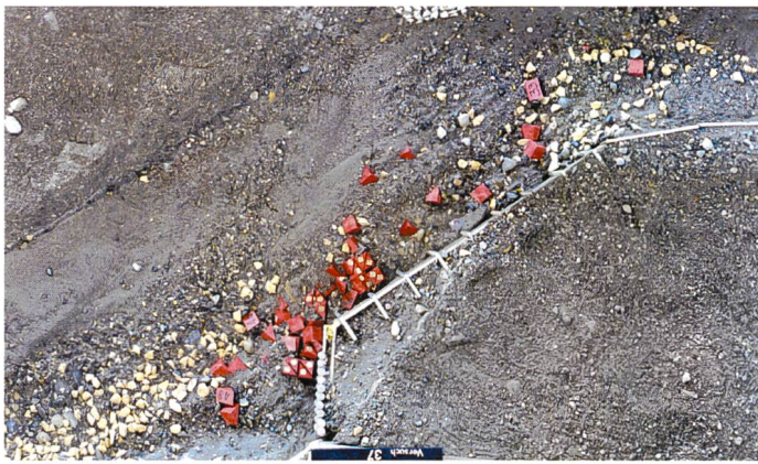
Bild 12. Flussaufwärtiges Ende der rechten Uferschutzmauer im hydraulischen Modell Gurtellen nach der Simulation eines Extremereignisses mit einem Abfluss von 1000 \text{ m}^3/\text{s} . Rund \frac{1}{4} der zum Schutz der Mauer versetzten Prismen wurde abtransportiert (Fließrichtung von links nach rechts).
