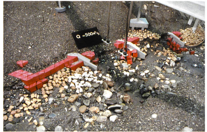
Bild 7. Bei der Nationalstrassenbrücke Wassen sind die drei bühnenförmigen Betonscheiben, welche die Strömung vom linken Ufer abweisen durch Betonprismen vor Hinterspülung geschützt. Zustand im hydraulischen Modell nach einem Abfluss von 500 m 3 /s (Fließrichtung von links nach rechts).
