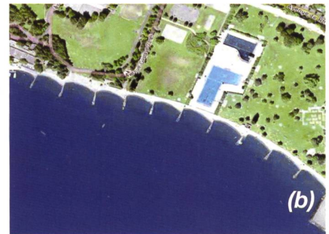
Figure 1. Protection des rives par des mesures souples: (a) protection des roselières par des barrages à claire-voie sur le lac de Biemme; (b) stabilisation par matériaux fins et épîs à Bellerive sur la rive nord du Léman.
