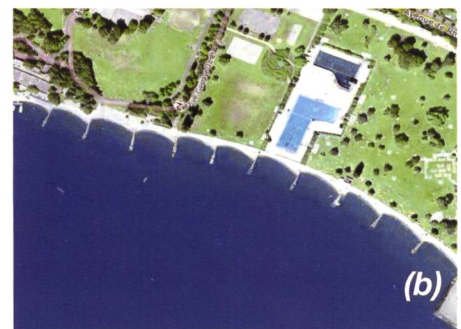
Figure 1. Protection des rives par des mesures souples: (a) protection des roselières par des barrages à claire-voie sur le lac de Bienne; (b) stabilisation par matériaux fins et épis à Bellerive sur la rive nord du Léman.
