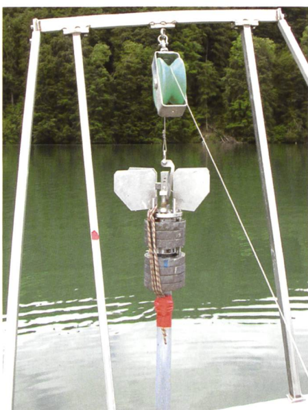
Bild 6. Kurzkerngerät zur Entnahme ungestörter Sedimentproben (Gerät und Foto: Gewässer- und Bodenschutzlabor des Kantons Bern).
