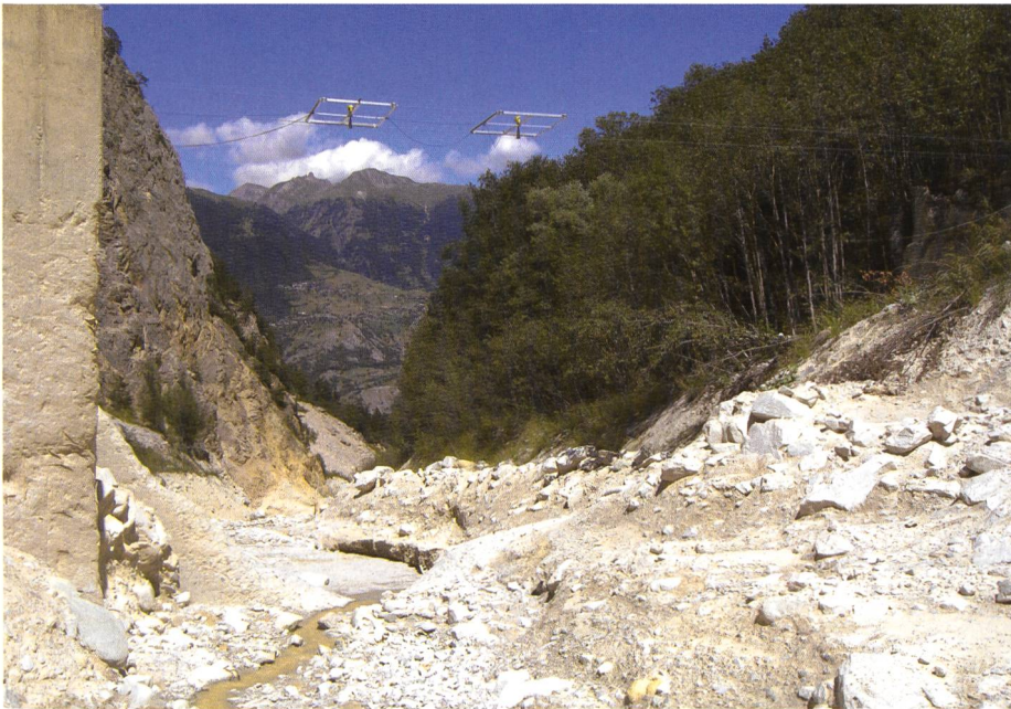
Bild 5. Bestimmung der Abflusshöhe mittels Radarsensoren im oberen Einzugsgebiet des Illgrabens (C. Graf, WSL).
