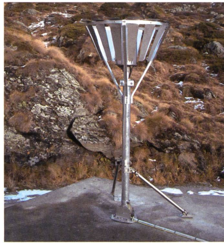
Bild 4. Manuelle Pegelmessstelle im Gebiet Simplon Süd (links), automatische Niederschlagsmessstation im Gebiet Verbier (rechts).
