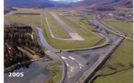
Bild 8. Rechte Bildleiste: Neue Flazmündung (Blick von Gravatscha En-aufwärts in südlicher Richtung): Die neue Flazmündung unterhalb von Samedan stellt eine technische Lösung mit naturnahen Elementen dar. Damit das Wasser von Gravatscha nicht durch Flazwasser, welches häufig Gletschermilch enthält, getrübt wird, wird der See durch einen Düker unter dem Flaz hindurch mit Enwasser gespeist. Der auf der linken Flazseite in die Mündung vorgezogene Sporn wurde zwischenzeitlich stark abgetragen.
