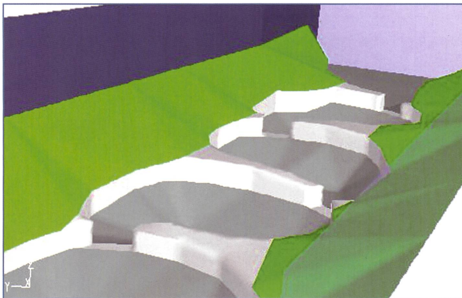
Bild 2. 3-dimensionales Modell der Pendelrampe.
