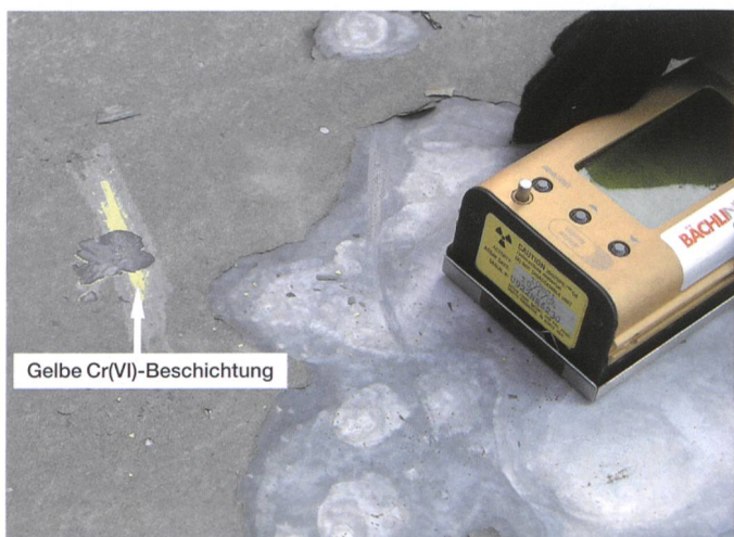
Bild 5. Voruntersuchung vor Ort mit mobilem Röntgenfluoreszenzspektrometer.
