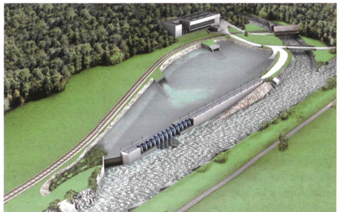
Bild 3. Schematische Darstellung des geplanten Beruhigungsbeckens zwischen Aare, Gadmerwasser und der Meiringen-Innertkirchen-Bahn.
