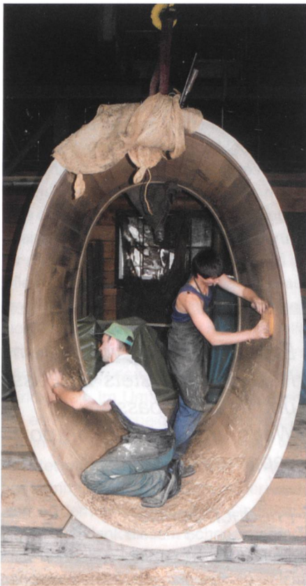
Bild 3. Aushobeln des Fassinnern.
