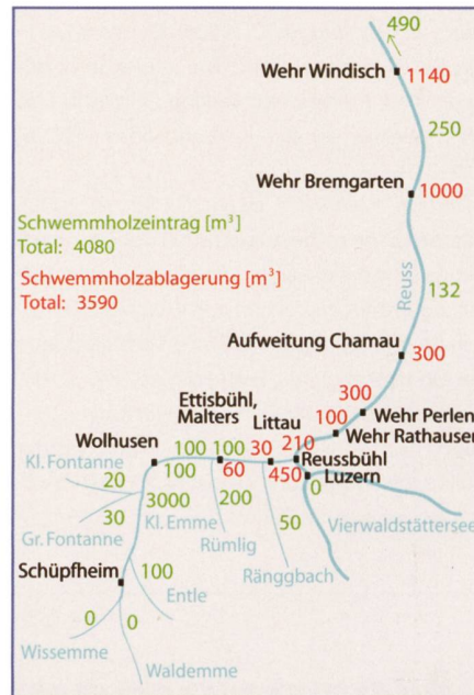
Bild 1, links. Übersicht über das Projektgebiet, rechts: Schwemmholzbilanz für das Hochwasser im August 2005 [m 3 Festvolumen] (Quelle: Versuchsanstalt für Wasserbau, Hydrologie und Glaziologie).
