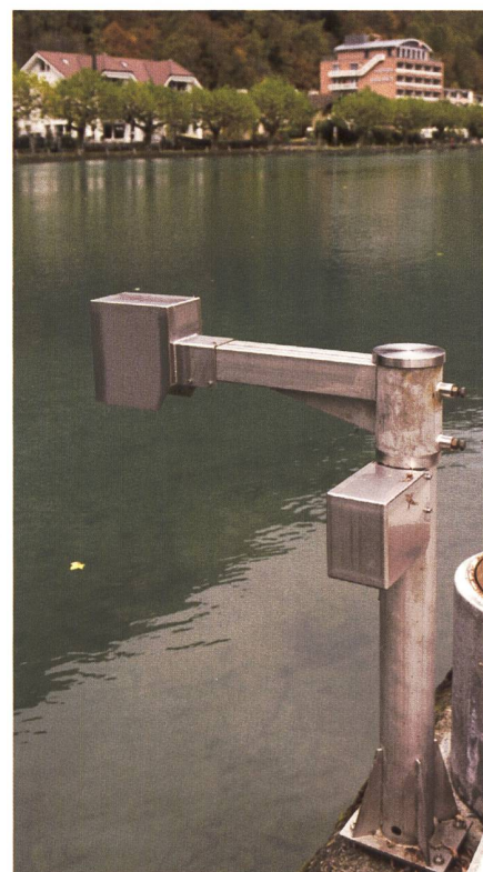
Bild 10. Neue Radarmesseinrichtung zur Messung des Oberwassers. Für Wartungsarbeiten ist der Arm mit dem Radar schwenkbar (Quelle [2]).
