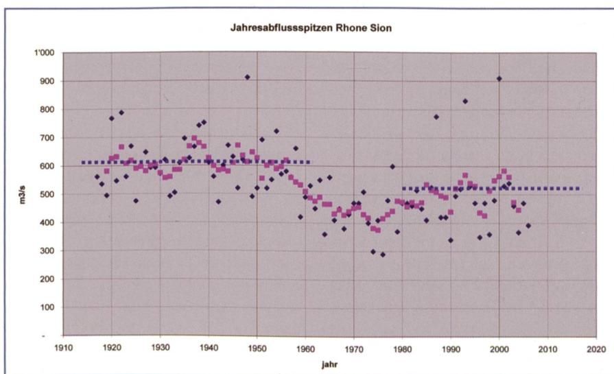
**Bild 6. Reduktion der Abflussspitzen der jährlichen Hochwasser an der Rhone bei Sion nach dem Bau der grossen Kraftwerksspeicher in den 50er- und 60er-Jahren des 20. Jahrhunderts (Blau: Jahresabflussspitzen, Magenta: 5-jährliche gleitende Mittel).**
