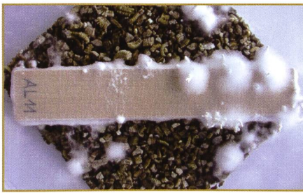
Bild 4. Mit Pilzen infiziertes Fichtenholzprobe an der Empa.
