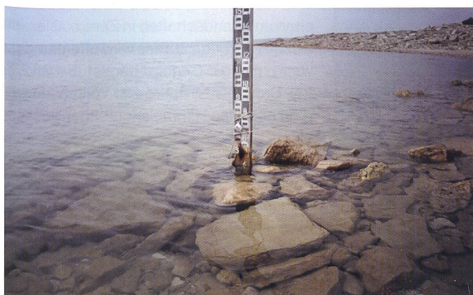
Bild 14. Lattenpegel Aktunsuk am Westufer des Aralsees, zwischenzeitlich verschoben. Einzige langjährige Messeinrichtung (Bild: Herbert Rothen, Murten, 2001).
