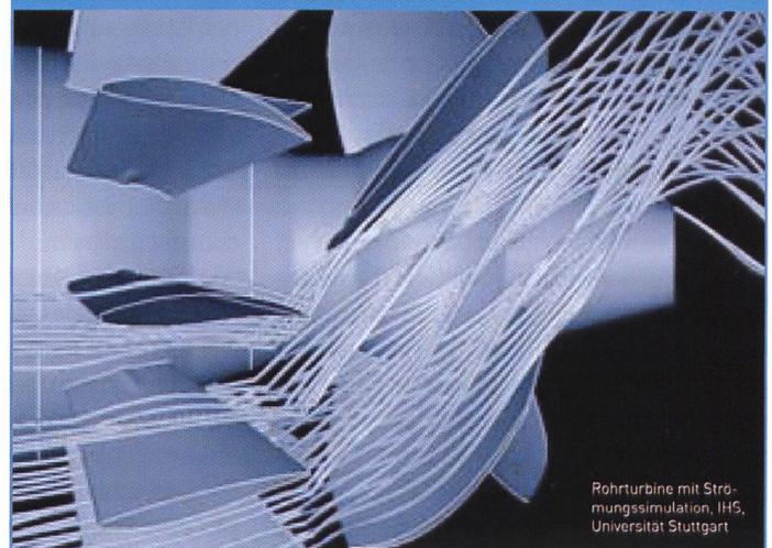
Rohrturbine mit Strömungssimulation, IHS, Universität Stuttgart
