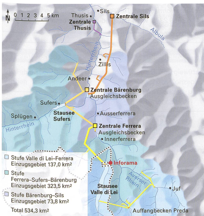
Bild 3. Energie aus Wasserkraft in Graubünden: Hydraulische Übersicht der Kraftwerke Hinterrhein.
