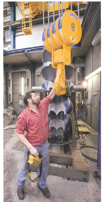
Bild 1. Vorbereitungen zum Abtransport eines Francis-Laufrades. (Bilder: P. Meier/Feurstein).
