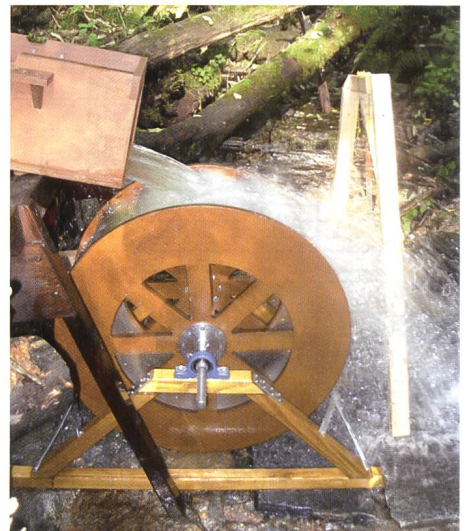
Bild 8.13. Grosses Gespritze bei geringer Belastung und viel Wasser.
