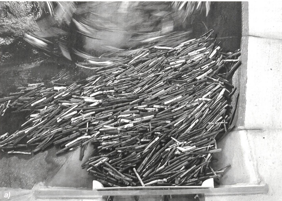
Bild 4. Von der Sohle bis über den Wasserspiegel verlegter Grobholzrechen (LF 2, nach Zugabe von 150 m 3 Festholz), von der Rückseite betrachtet und nahe der unteren Rechenstirnseite.
