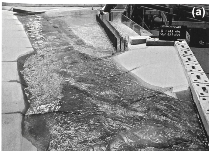
Bild 4. Strömungsbild beim Einlaufbauwerk bei EHQ mit geschlossenem Drosselwehr, (a) Ausgangsentwurf und (b) Ausführungsvorschlag.
