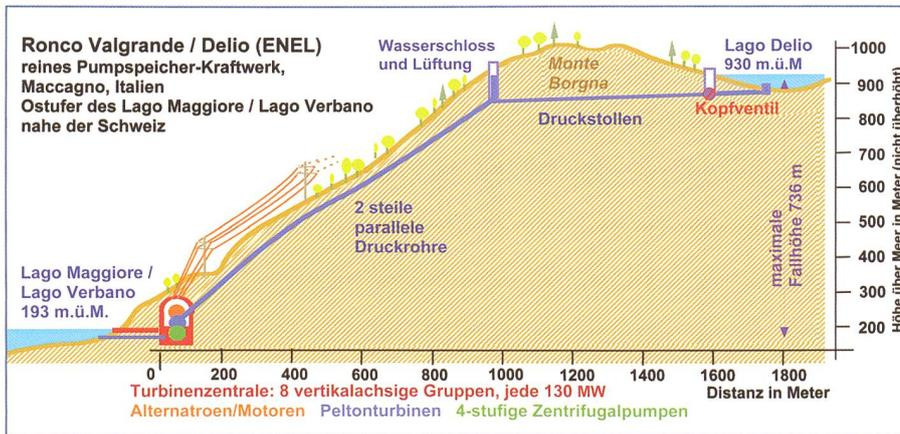
**Bild 1. Querprofil-Schema des Pumpspeicher-Kraftwerks Ronco Val Grande – Lago Delio, Italien (Grafik Speich).**
