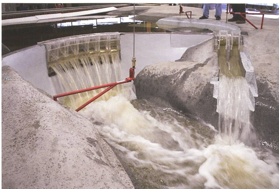
Figure 7. Cambambe, essais sur modèle hydraulique physique, 2010–2012.
