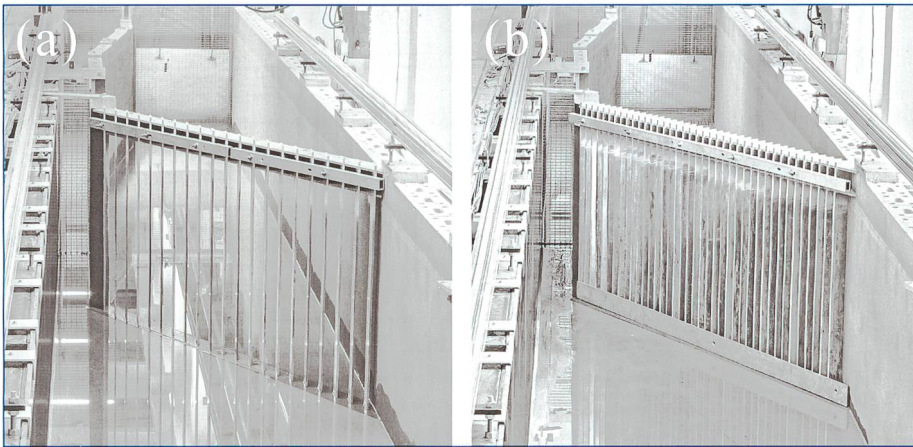
Bild 7. Leitrechen im ethohydraulischen Modell: (a) Kontrollkonfiguration und (b) modifiziertes Bar-Rack mit Sohleitwand.
