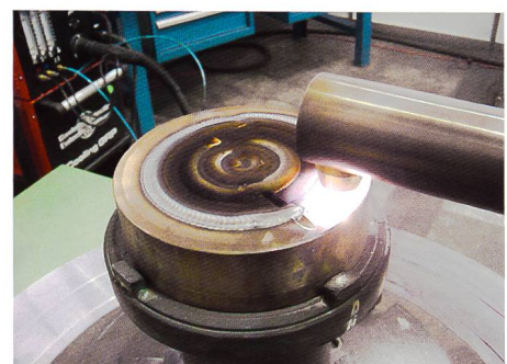
Bild 3. Versuchsplatte mit PTA geschweisst.
