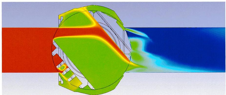
Bild 2. Visualisierung der Strömung durch den Kugelschieber.
