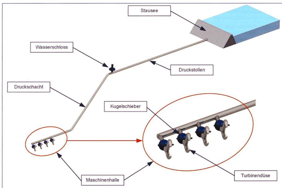
**Bild 1. Kraftwerkslayout komplett.**
