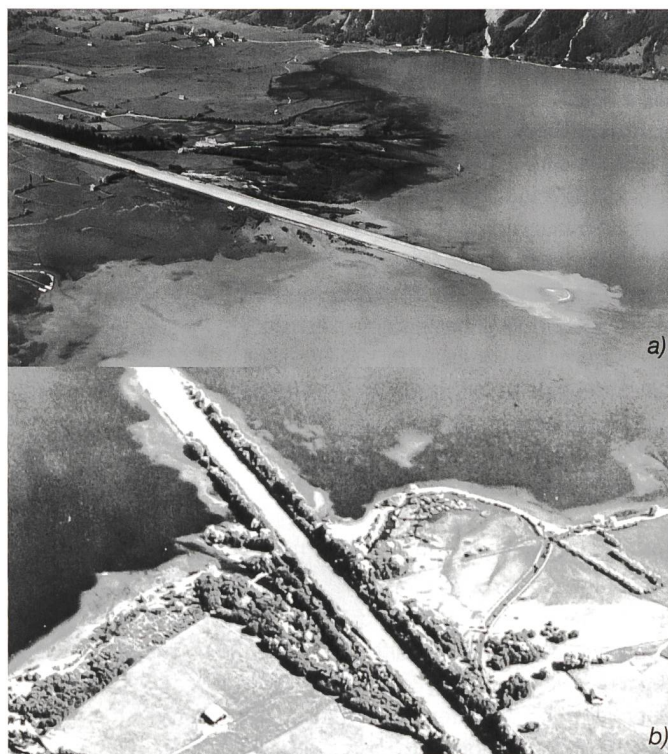
Bild 2. Mündunginsel vor der neuen Reussmündung (Bild 2a; Aufnahme Swissair Photo) und Zustand vor Inangriffnahme des Reussdeltaprojekts (Bild 2b, O. Lang, Uster).
