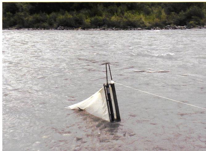
Bild 4. Messeinrichtung Feldversuche (links: überströmtes Flachnetz bei Schwall, rechts: Driftnetz bei Schwallanstieg).
