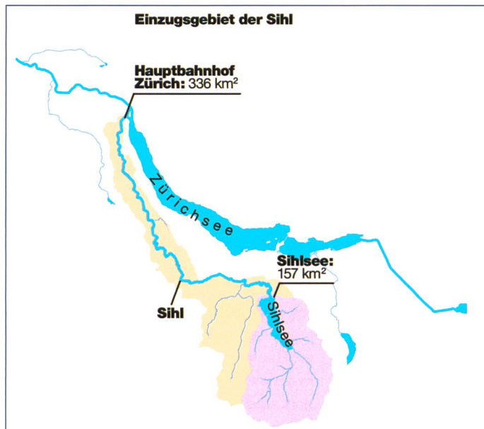
Bild 2. Knapp die Hälfte des Einzugsgebiets der Sihl liegt oberhalb des Sihlsees.
