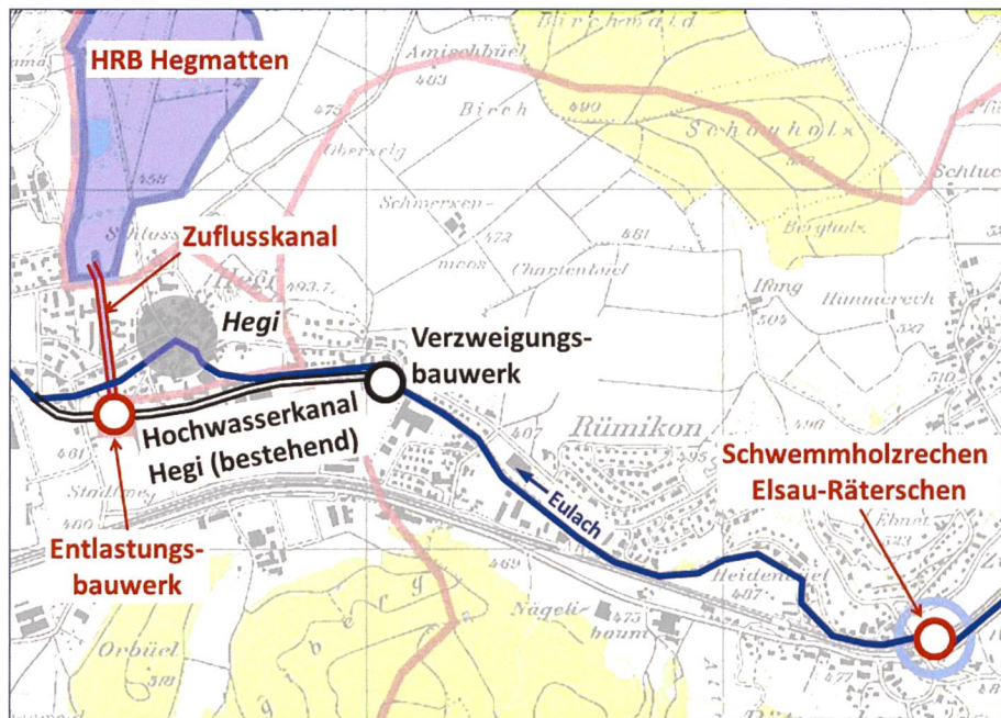
Bild 2. Projektübersicht HRB Hegmatten – rot: neu realisierte Projektelemente.
