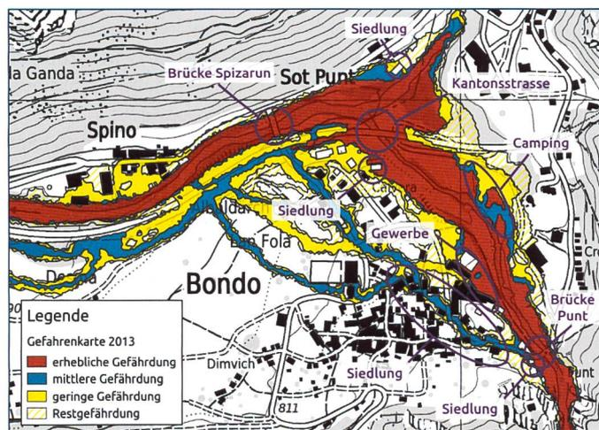
**Bild 6. Gefahrenkarte Wasser 2012/2013 und Schutzdefizite (vor Schutzmassnahmen Bondo I, Quelle: [1]).**
