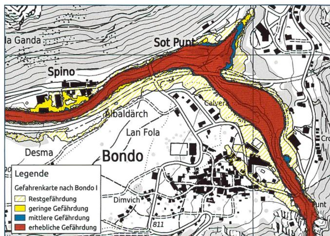
Bild 8. Gefahrenkarte Wasser 2016 nach Schutzmassnahmen Bondo I 2014/15.
