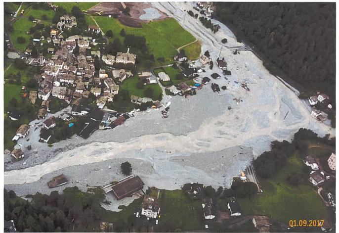
**Bild 4. Ablagerungen im Bereich des Auffangbeckens in Bondo nach den Murgängen vom August 2017.**
