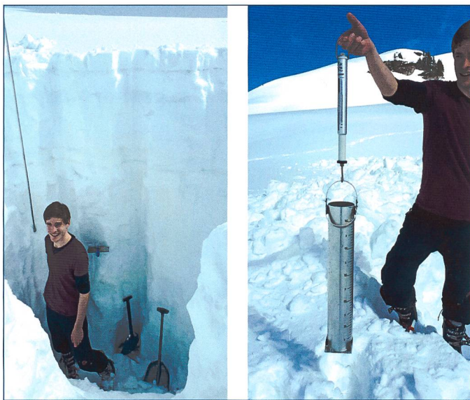
Bild 2, oben. Schneedichtemessung mit der sog. ETH-Sonde.
