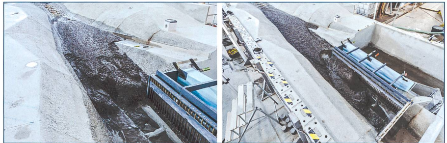
Bild 8. Links: Auflandungskörper und Lage der Verlandungsfront nach Ende eines ersten HQ_{300} -Versuchs. Rechts: Auflandungskörper nach Ende eines zweiten HQ_{300} -Versuchs mit massivem Geschiebeeintrag in den Stollen. Blick jeweils gegen die Fliessrichtung.
