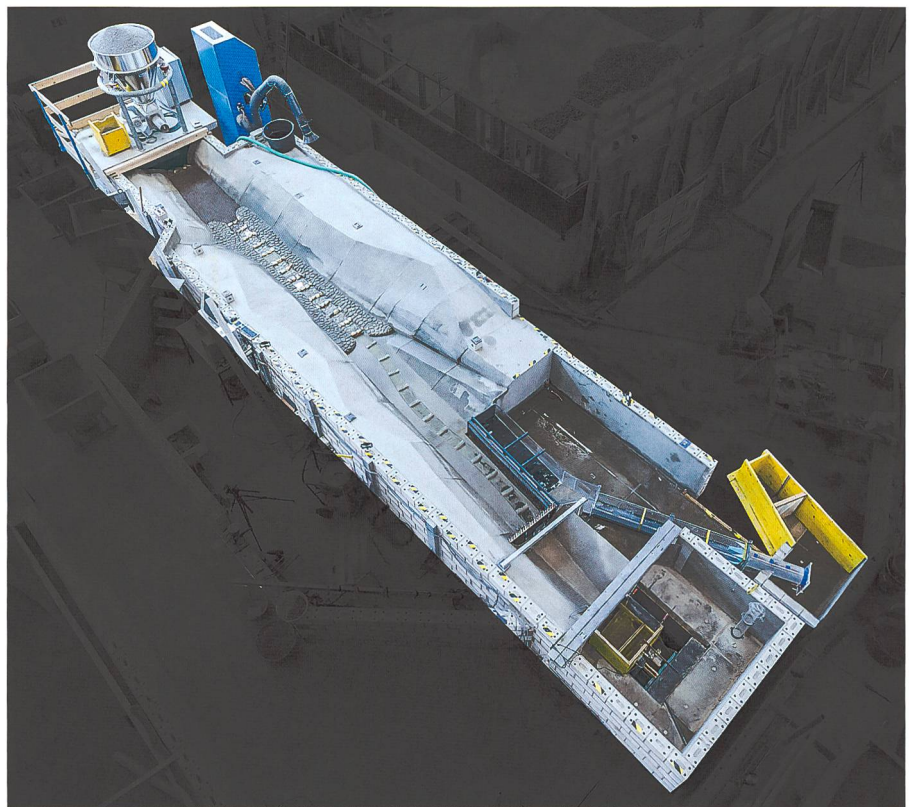
Bild 5. Hydraulisches Modell des Einlaufbauwerks Würzenbachstollen im Massstab 1:15. Fließrichtung von links nach rechts.
