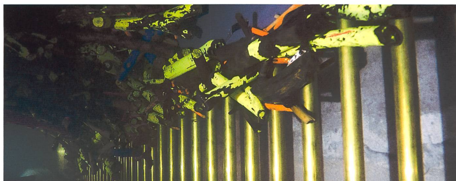
Bild 13. Im Vergleich zu Variante TW II (vgl. Bild 10) deutlich reduzierte Verklauungsanfälligkeit der Bestvariante «Rechen mit Blende». Blick gegen die Fließrichtung.
