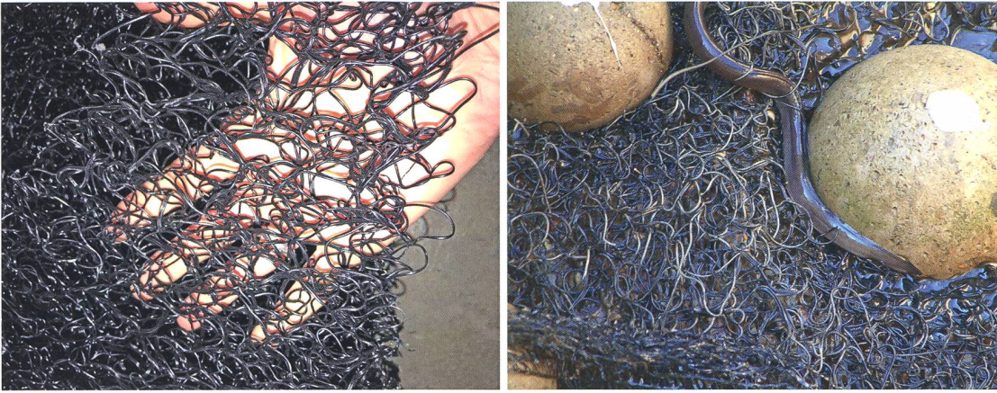
Figure 2: A gauche: geogrid en PE avant la construction (photo: M. Mende); à droite: civelle sur la géogrid d'une passe à méandres asséchée (photo: fabricant).
