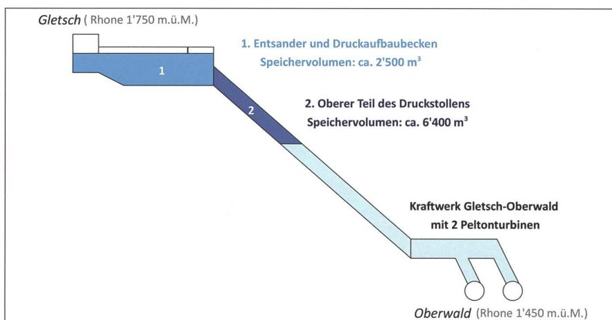
**Bild 2:** Diese (nicht massstabsgetreue) Darstellung zeigt die Bereiche, die als Speicher genutzt werden können: das Entsanderbecken und das Druckaufbaubecken sowie der obere Teil des Druckstollens. Grafik: SmallFLEX, bearbeitet C. Münch/HES-SO Valais-Wallis.
