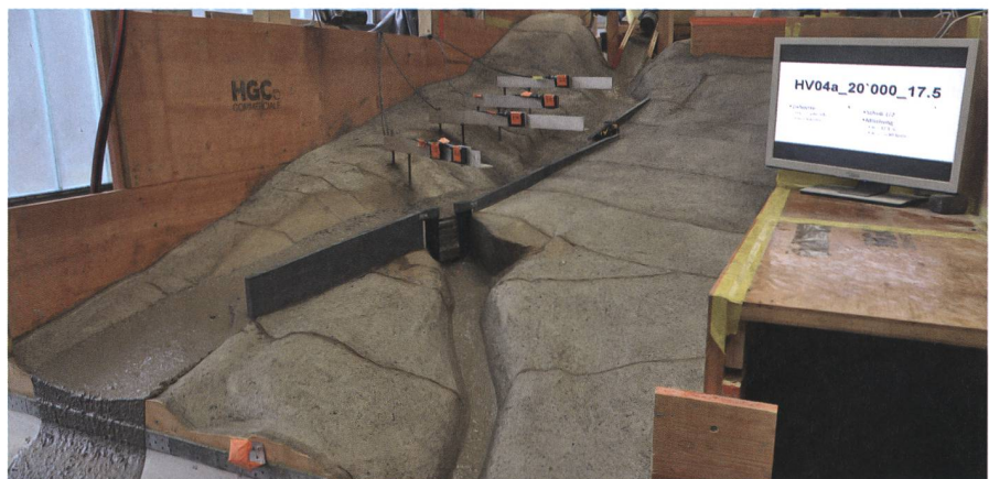
Bild 1: Murgangversuch am Labormodell.
