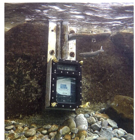
Bild 2: Unterwasserkamera an der Installationsvorrichtung, eingebaut am Untersuchungsstandort mit einer Bachforelle (ca. 20 cm) im Vordergrund.
