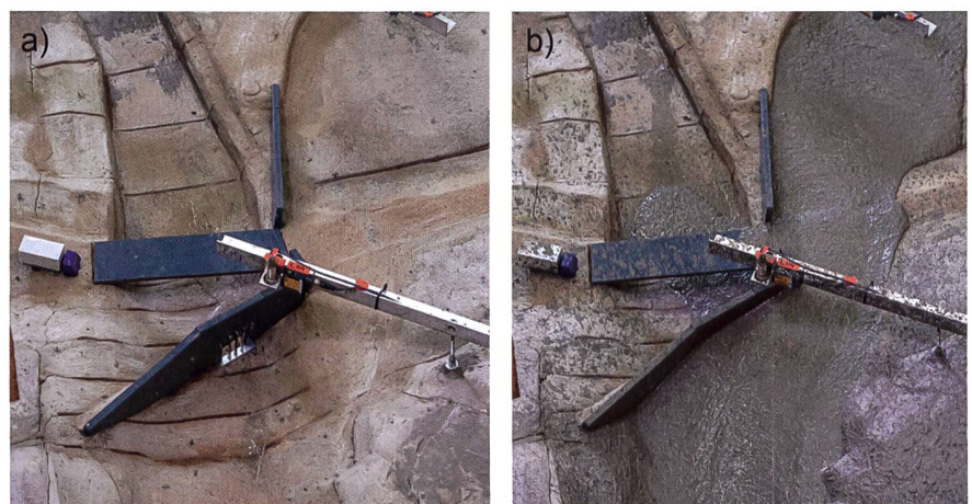
Bild 4: Draufsicht auf das Ausleitbauwerk (a) vor und (b) nach einem Versuch (Berger et al., 2020).
