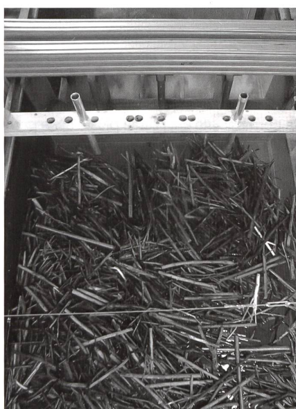
Figure 9: Essai avec un râtelier partiel et une quantité extrême de bois flottant (test 278).
