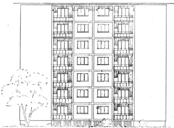
Projekt «Im Moos». Haus mit 7 Stockwerken Südteil mit 2-Zimmer-Wohnungen
