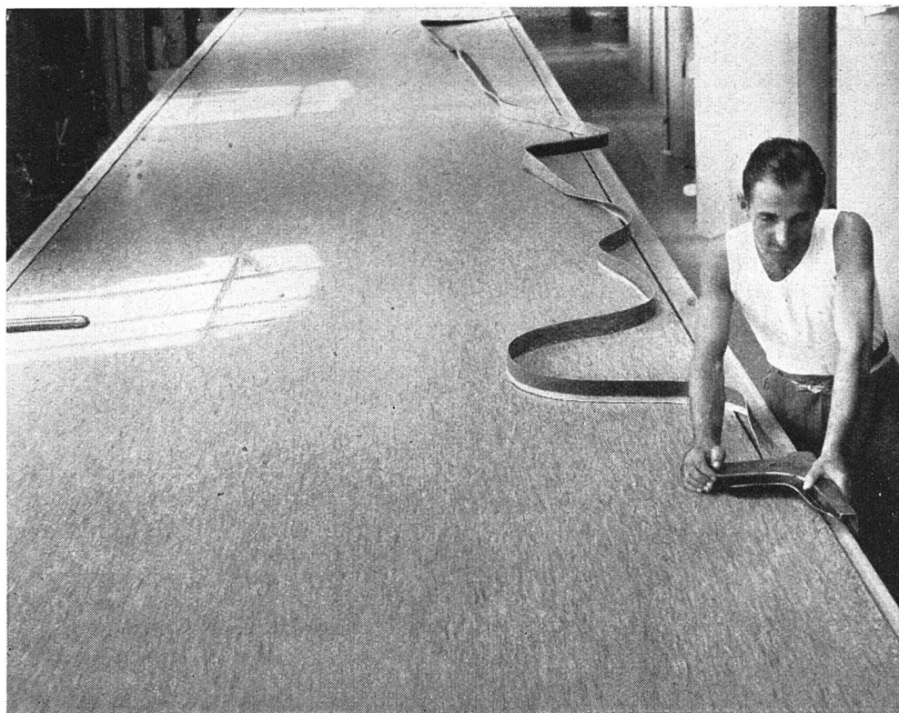
Abb. 7: Die Ränder der Linoleumbahn werden mit dem Schneidehobel auf die Normalbreite von 200 cm zugeschnitten. Dann wird das Linoleum gerollt und ins Lager gestellt.
