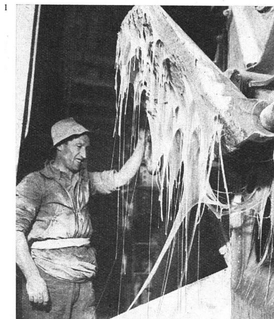
Abb. 2: Aus dem gemahlenen Linoxyn entsteht nach Zusatz verschiedener Harze der Linoleumzement, eine zähe, kautschukartige Masse, die in Form von «Fellen» gelagert wird.
