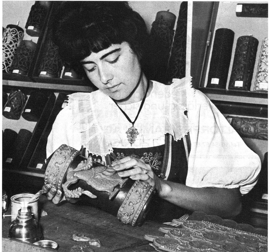
Das flache Wachspositiv wird auf die runde Kerze aufgebracht.
