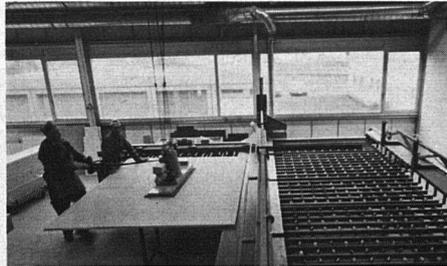
*Alle Produktionsanlagen sind mit modernsten Maschinen und Einrichtungen ausgestattet. Auf dieser Zuschneidemaschine zum Beispiel werden die Spanplatten automatisch auf das gewünschte Format zugeschnitten.*
