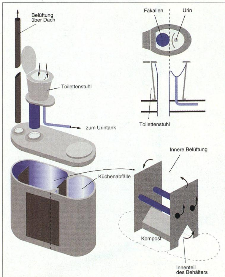
Die Revolution in der MFH-Praxis: Komposter (a), parallel verlegte Abwurfrohre (b), Keramiktoilette mit Trennsystem (c).
