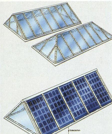
Photovoltaik-Elemente machen das Langlicht sehr vielseitig. Das neue normierte Langlicht-System deckt den Bereich zwischen 2 und 4,8 m Spannweite in Sprüngen von 10 cm ab. Dazu werden für die Sprossen zwei Profilhöhen eingesetzt: 50 mm und 80 mm. Der Länge sind theoretisch keine Grenzen gesetzt. Die kann durch die variabel aufteilbaren Glasfelder exakt dem geforderten Mass angepasst werden.
