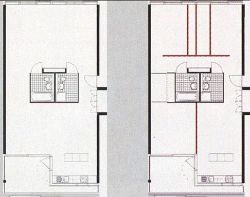
Zwei Betonscheiben und raummittig gesetzte Nasszellen definieren den Spielraum in der Grundrissgestaltung. Zwischen den Tragmauern können Wände (rot markiert) in vielen Variationen gesetzt werden. 18 Grundvarianten von der 1- bis zur 6-Zimmer-Wohnung wurden nach diesem Konzept entwickelt und gebaut.
