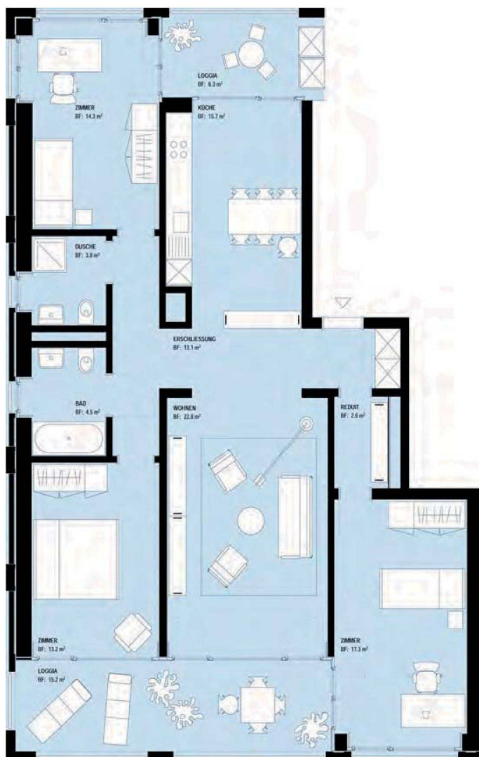
Grundrissbeispiele von Viereinhalbzimmerwohnungen mit 107 und 112 Quadratmetern Fläche.
