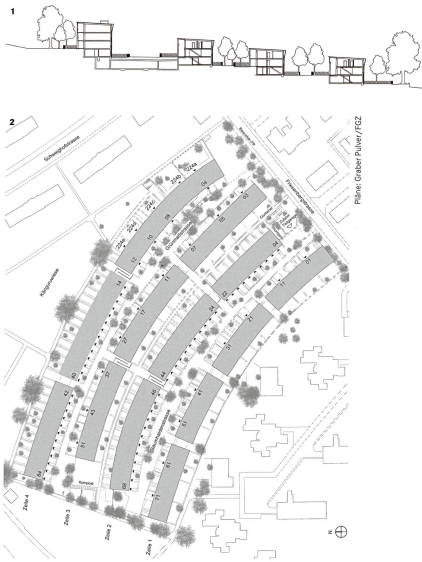
1 In der Schnittzeichnung wird die Abtreppung deutlich, dank der alle Aussenräume ebenerdig sind. 2 Gesamtsituation der Neubausiedlung Grünmatt. Die viergeschossige (bergseitig dreigeschossige) Zelle 1 liegt zuoberst, während Zeilen 2 bis 4 dreigeschossig beziehungsweise zweigeschossig sind.
